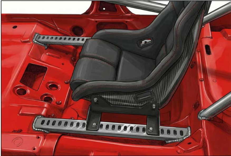
Figur visar montering av stol på skenor med "ETT" stolsfäste på sidan Fäste mot skena är monterad med två (2) st M8
