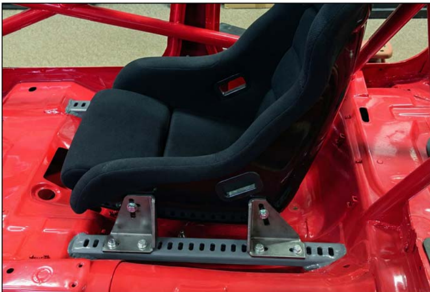
Figur visar montering av stol på skenor med "TVÅ" stolsfäste på sidan Fäste mot skena är monterad med fyra (4) st M8
